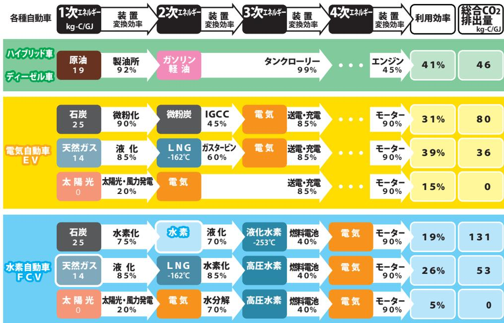
各行の上段はエネルギーの名称と、エネルギーを変換したり輸送する装置、下段が装置のエネルギー変換効率。
